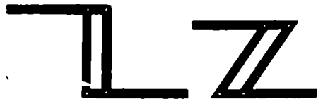
Фиг. 7. Принцип устройства параллельной линейки.
